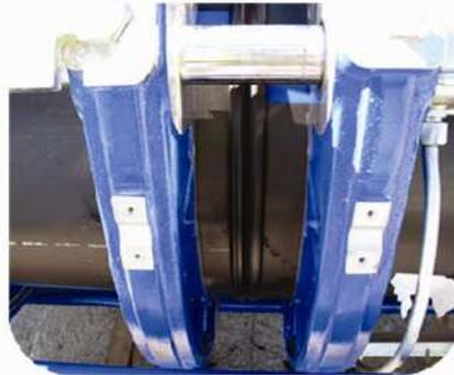
(2) Union des tubes par soudure en **tronçons de 65 m** (durée approximative = 1,5 hr./soudure).
