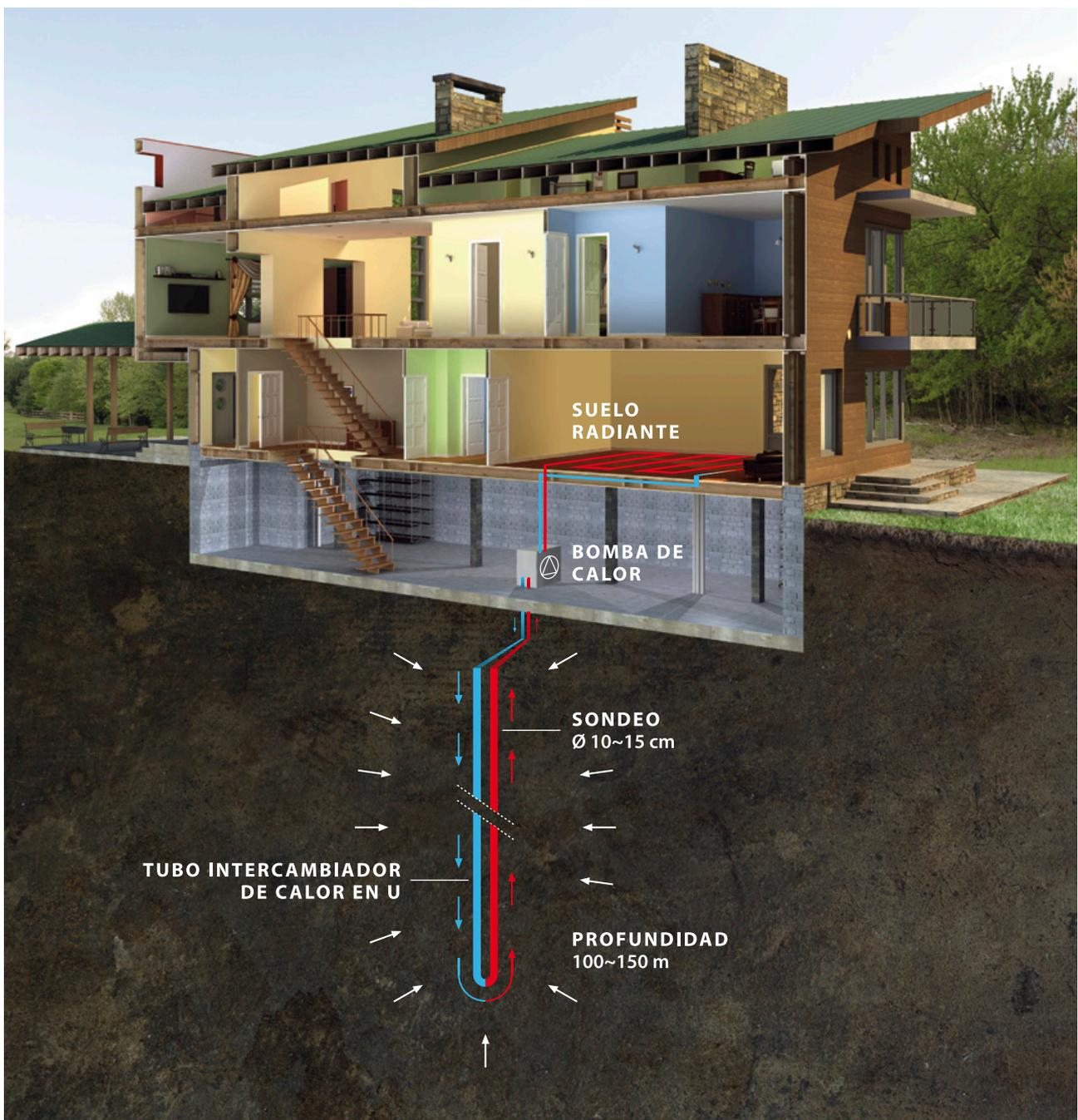
El sistema geotérmico FERROTERM es un sistema cerrado de baja temperatura para aplicación con bombas de calor geotérmicas, con captaciones en horizontal y vertical mediante sondas de polietileno.
